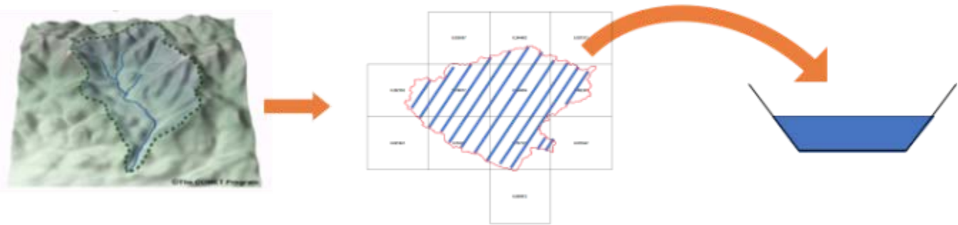
Figura 3.3. Una ilustración de una implementación de asignación definida por el usuario para transformar flujos y estados mallados en flujos y estados agregados de captación, que pueden pasarse, por ejemplo, a módulos de enrutamiento en canales basados en vectores.
